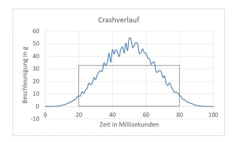
Die Geschwindigkeitsdifferenz entspricht der Fläche unter der Kurve. Zeichnen Sie ein Rechteck gleicher Fläche: z.B. Höhe: 32 g, Zeit: 20 ms bis 80 ms. Deshalb:
